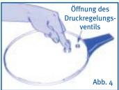
Lässt sich der Stöpsel nach innen drücken, so funktioniert das Sicherheitsventil korrekt. Wenn der Stöpsel nicht nachgibt und verklemmt ist, muss er gelockert und gereinigt werden, wie auf **Seite 10** beschrieben. Setzen Sie den Deckel auf den Topf, und zwar so, dass der kleine Kreis auf
